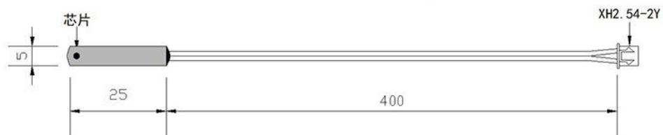
产品图纸供参考；可按需求参数、规格、长度定制（来图来样）
